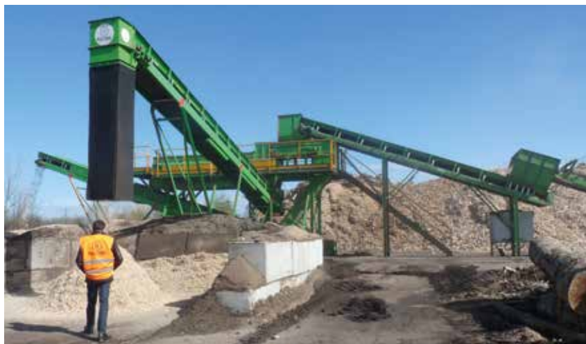
^ L'outil de criblage fixe sur le site de l'Ecopôle La Rize, plus grande plateforme de valorisation des déchets verts et issus du bois de Racine.
