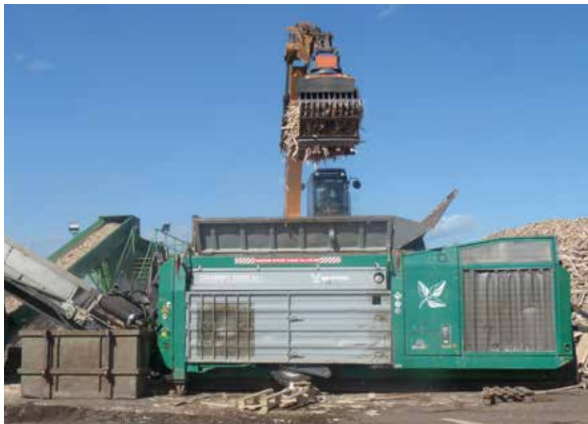
^ Racine est équipée de plusieurs broyeurs lents et rapides. Ici un broyeur lent, Crambo 5000 de Komptech.
